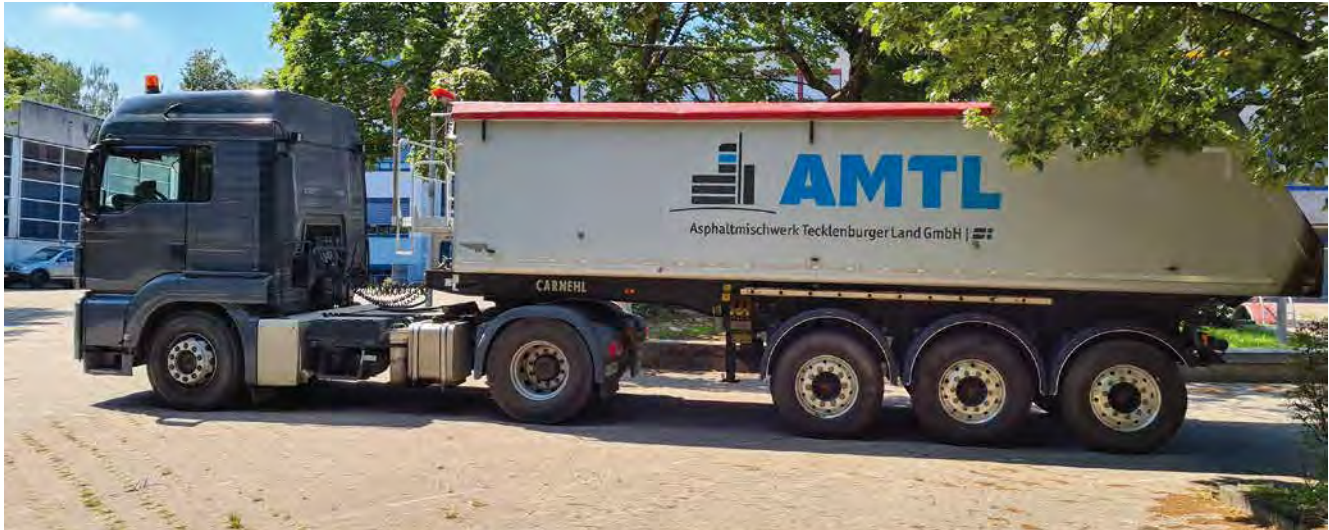
Bild 4: Die Anlieferung des Spezialasphaltes erfolgte ausschließlich mit Thermomulden
